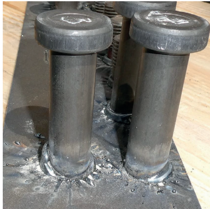
◀ Bild 15. Schweißungen mit den Messwerten aus Bild 14 (Bilder: DVS (8), Bolte)
