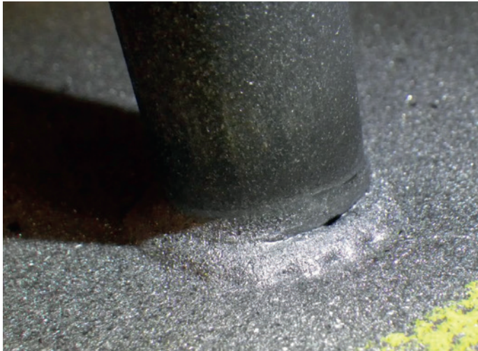
◀ Bild 4. Unterschneidung aufgrund von Eintauchbehinderung
