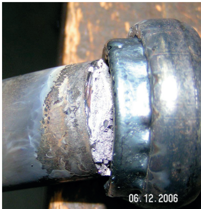
◀ Bild 3. Kleiner Bindefehler am Rand aufgrund von kaltem Eintauchen, Bolzen erreicht nicht den geforderten Biegewinkel von 60°
