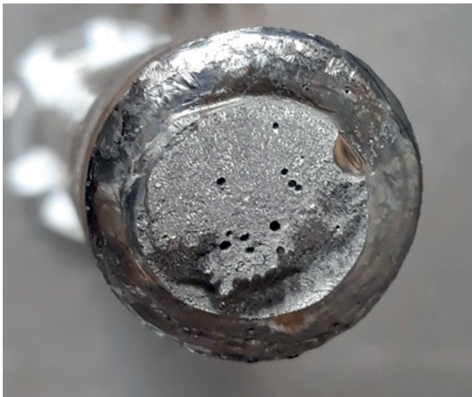
◀ Bild 5. Massive Bindefehler am Rand aufgrund von kaltem Eintauchen, Schweißzone versagt bei geringer Belastung
