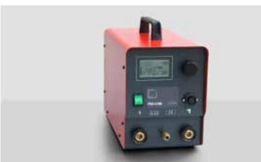
Die in den Bolzenschweißgeräten der Serien PRO-I, PRO-D, PRO-S und PRO-C standardmäßig integrierte Schweißparameterüberwachung ermöglicht eine Qualitätskontrolle der durchgeführten Schweißungen. Die Schweißparameterüberwachung bietet folgenden Leistungsumfang:
